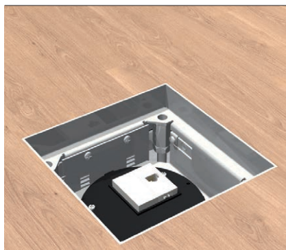
Монтаж установочных модулей В крышку UARM-2-1 118 вставить 2 установочных модуля 22,5x45 мм.
